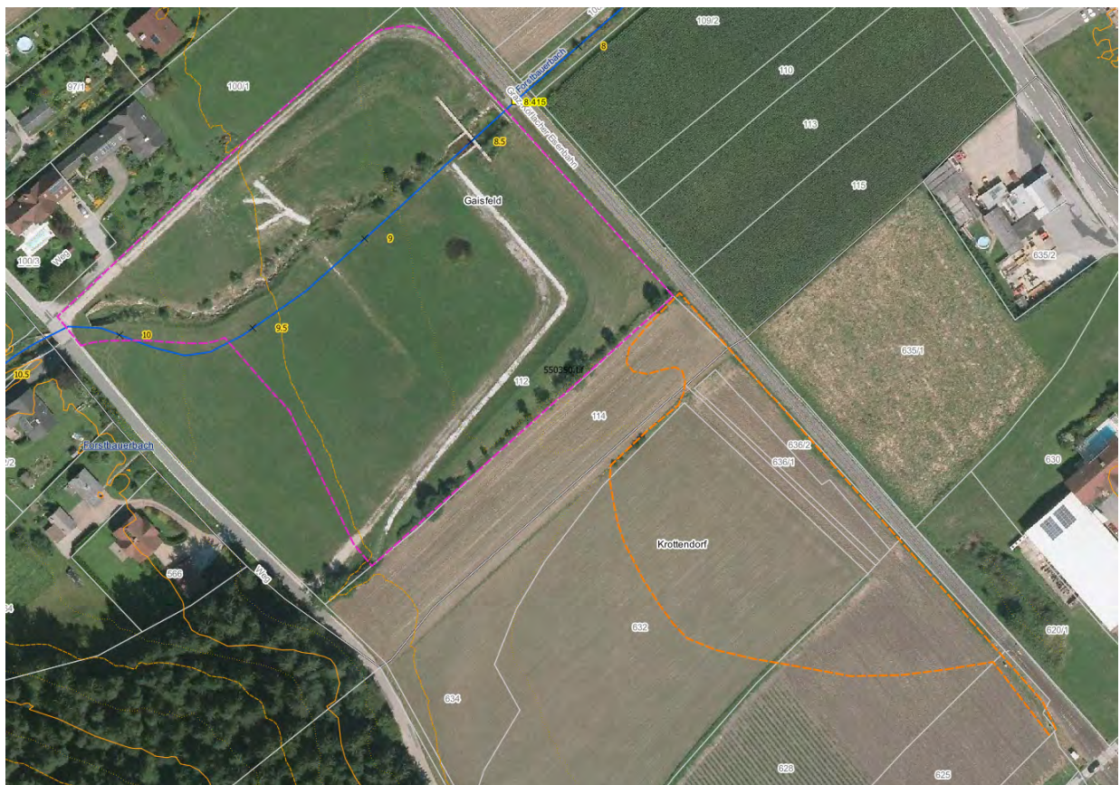
Abb. 1: Verbleibender Blauer Vorbehaltsbereich im Anlagenbereich des RHB (pink umrahmte Fläche), Fläche mit Stauhöhen größer 40 cm (orange umrahmte Fläche)
